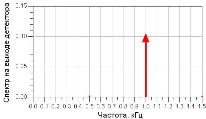
Рис. 3.5. Спектр сигнала на выходе амплитудного детектора
